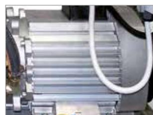
MOTEUR ÉLECTRIQUE SANS ENTRETIEN, REFROIDI PAR AIR ET DOTÉ DE PROTECTION THERMIQUE
